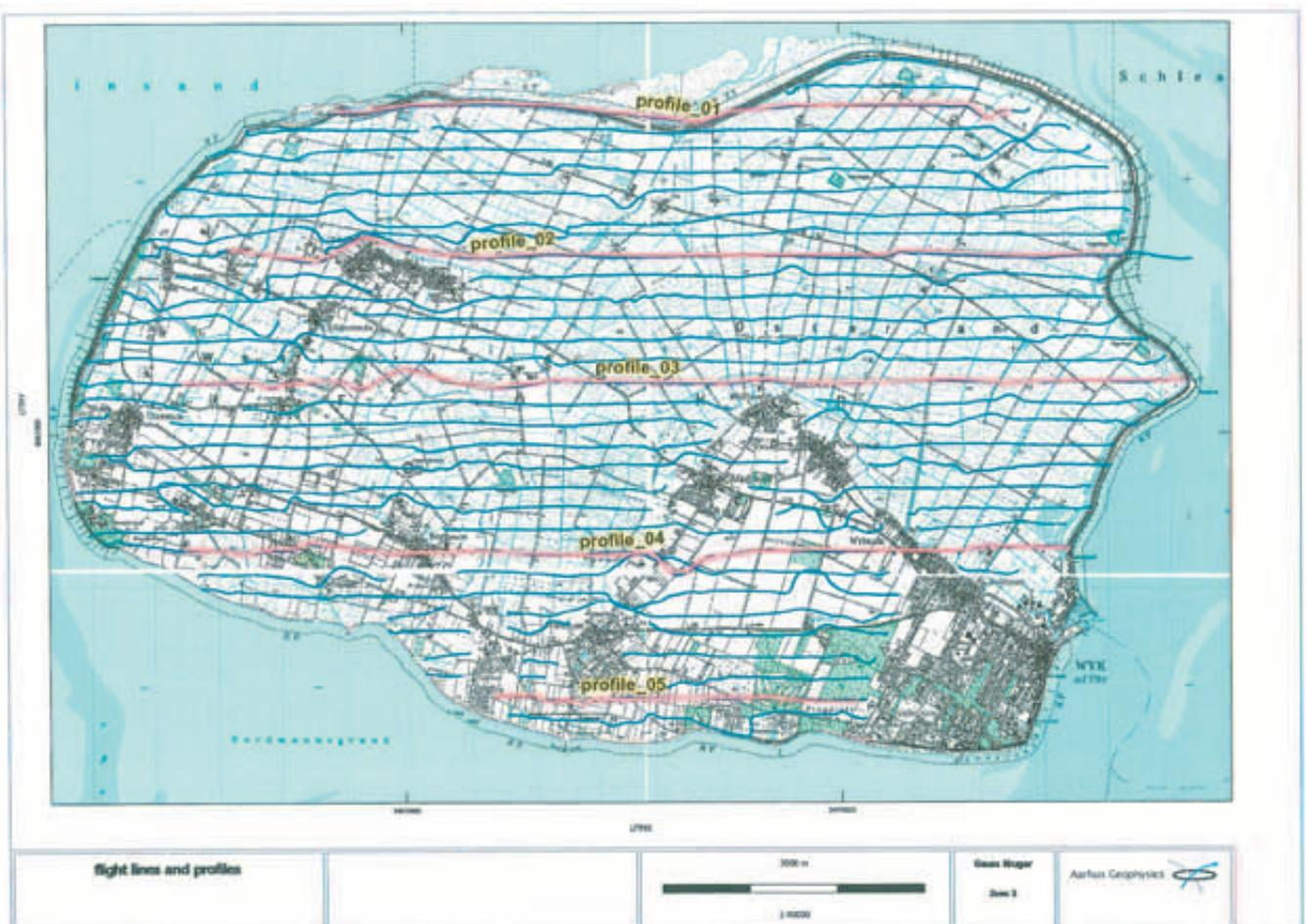
Abbildung 35: Fluglinienplan der SkyTEM Befliegung (blaue und rote Linien).
