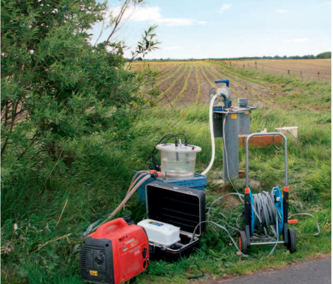
Abbildung 30: Probennahme mit kontinuierlicher Messung der Temperatur, des pH- Werts, der elektrischen Leitfähigkeit und des Sauerstoffgehalts in einer Messstelle auf der Insel Föhr.
