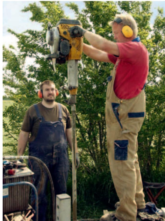
Abbildung 20: Rammkernsondierung. Ramming core sounding.
