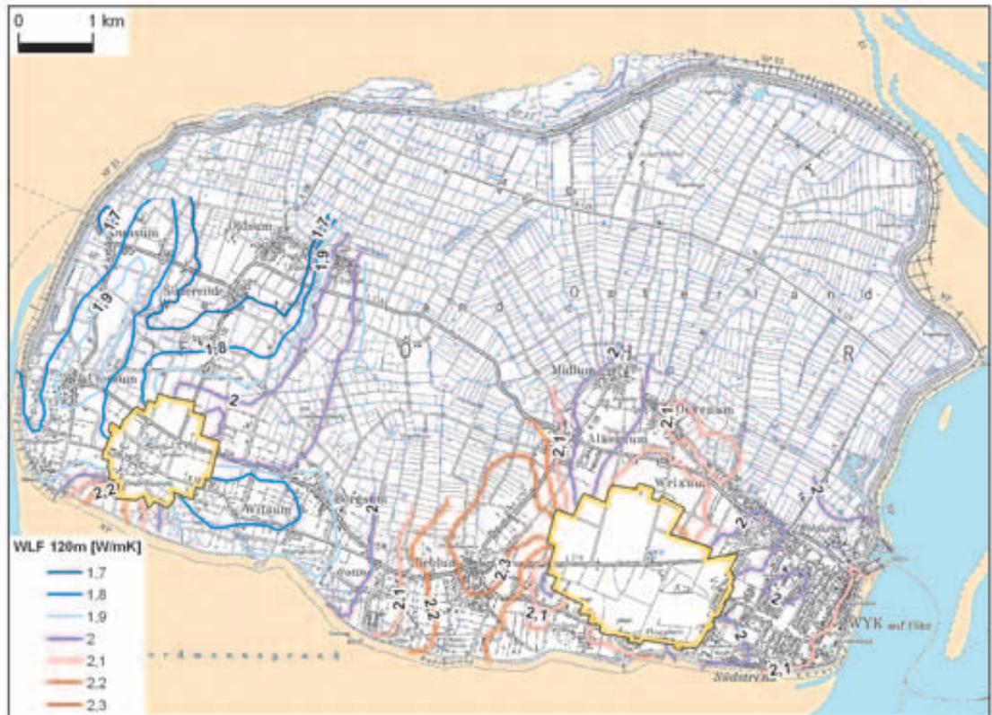
Abbildung 87: Effektive Wärmeleitfähigkeiten des Untergrundes für eine Bohrtiefe von 120 m. Die Wasser-schutzgebiete, in denen Bohrungen für Erdwärmesonden nicht zulässig sind, sind ausgespart (gelb umrandet).
