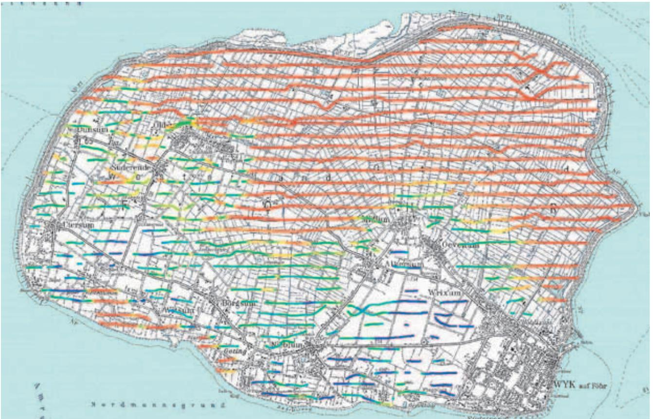
Abbildung 48: Verbreitung von Süß- (blau) und Salzwasser (rot) in einer Tiefe von etwa 10 m unter Gelände als Ergebnis der SkyTEM Befliegung.
