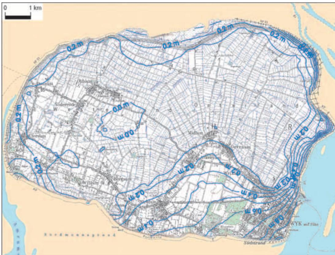
Abbildung 73: Berechneter Anstieg des Grundwasserspiegels im oberflächennahen Grundwasserleiter bis 2100, Differenzplan 2010 - 2100.
