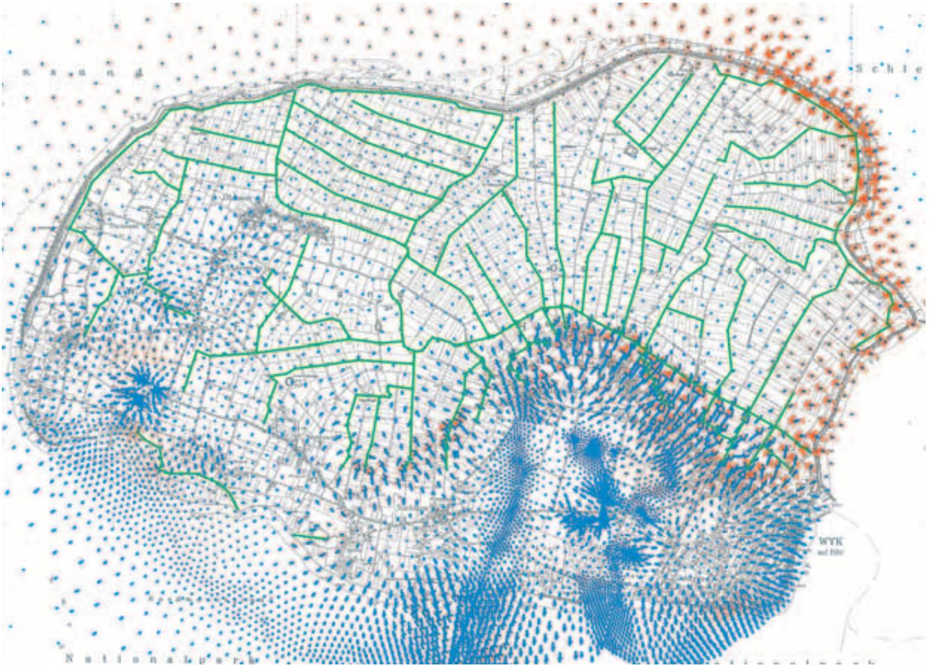
Abbildung 75: Grundwasserströmung. Die Pfeile geben die errechnete Richtung und Menge der horizontalen Grundwasserströmungen im oberen Grundwasserleiter an, blau: Grundwasserströmung 2010, rot: Grundwasserströmung 2100.
