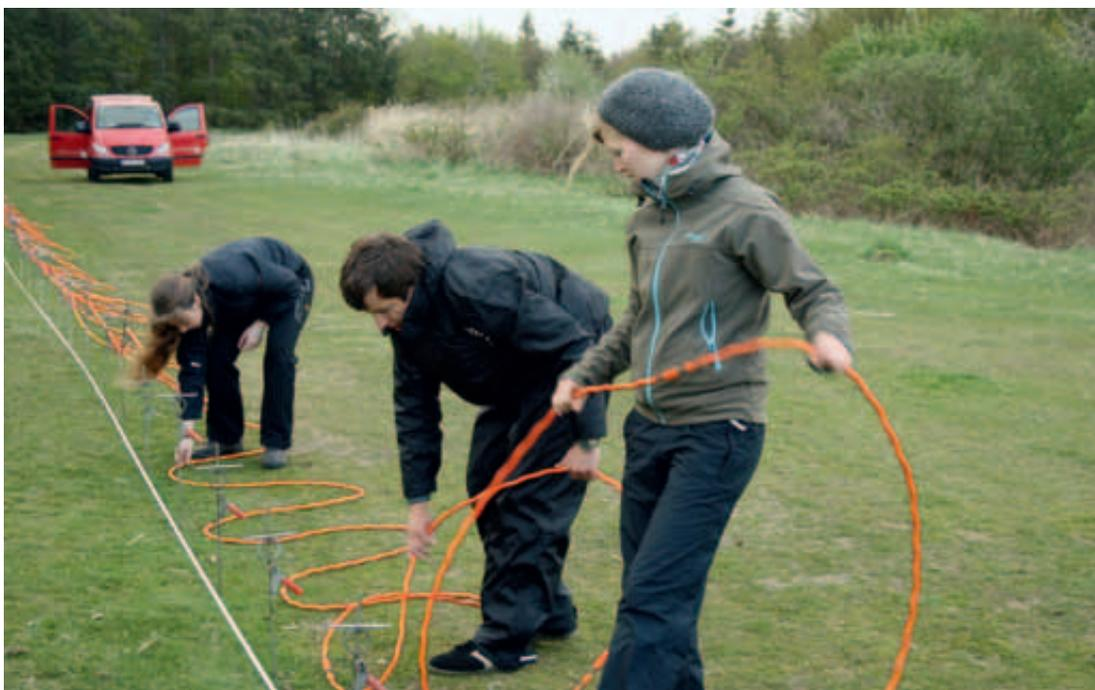
Abbildung 44: Geoelektrische Messungen der TU Berlin auf Föhr. Field crew of TU Berlin during geoelectrical measurements.
